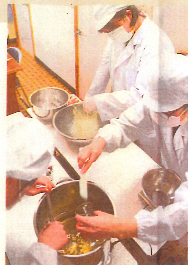
混合オイルと水酸化ナトリウム水溶液を別々に作り、それぞれ温度を45度にする
